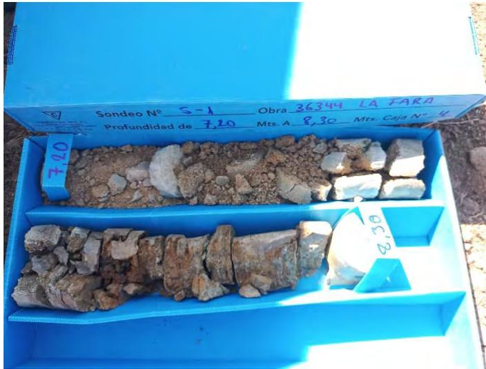
Foto 5. Vista testigo sondeo S-1 (7,2-8,3 m)
