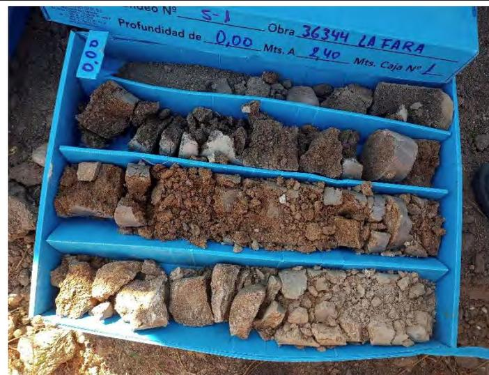
Foto 2. Vista testigo sondeo S-1 (0,0-2,4 m)
