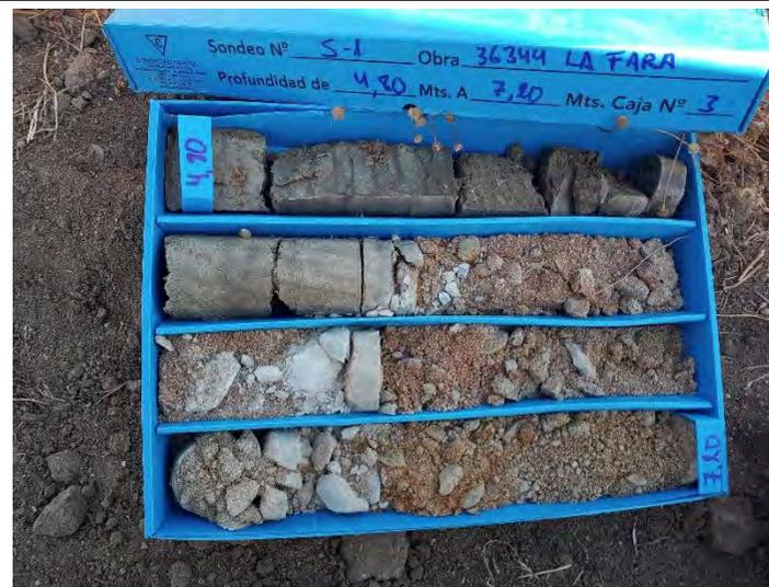
Foto 4. Vista testigo sondeo S-1 (4,8-7,2 m)
