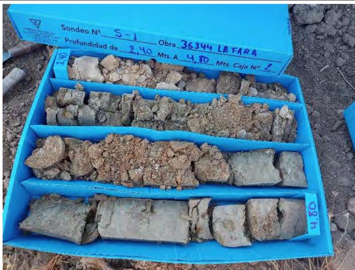
Foto 3. Vista testigo sondeo S-1 (2,4-4,8 m)
